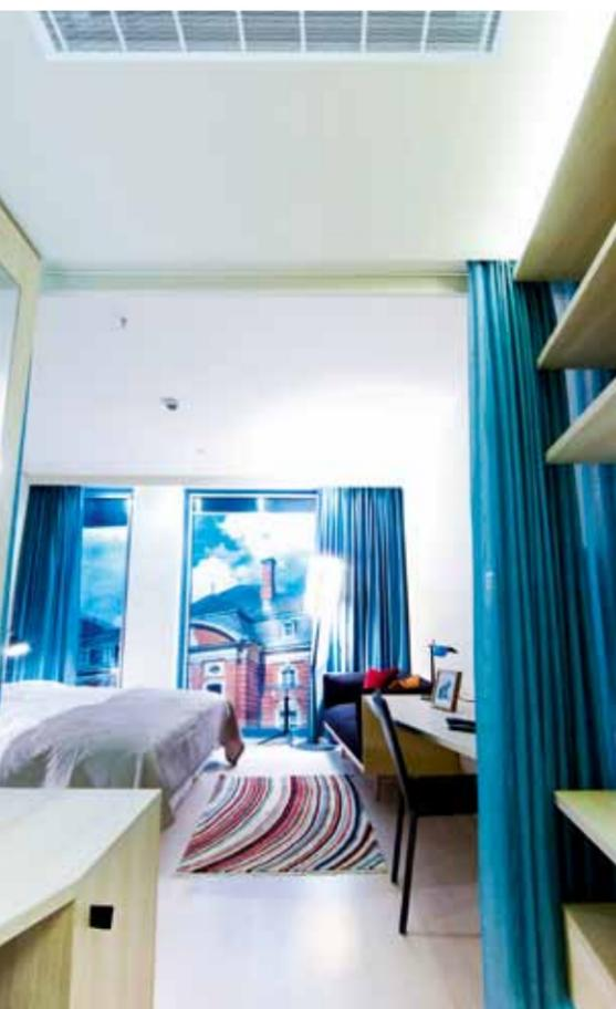
Im Flurbereich der Zimmer sind Deckeninduktionsgeräte unter der Decke eingebaut. Die Zuluft wird über verstellbare Lamellengitter ins Zimmer eingebracht und im Bad über Lüftungsventile wieder abgesaugt.
